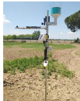
Figura 2 – Estação meteorológica para determinação das variáveis de cálculo de ET 0
