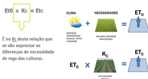
Figura 1 – Evapotranspiração cultural (ET c ) e sua relação com a evapotranspiração da cultura de referência (ET 0 ), segundo a FAO.
