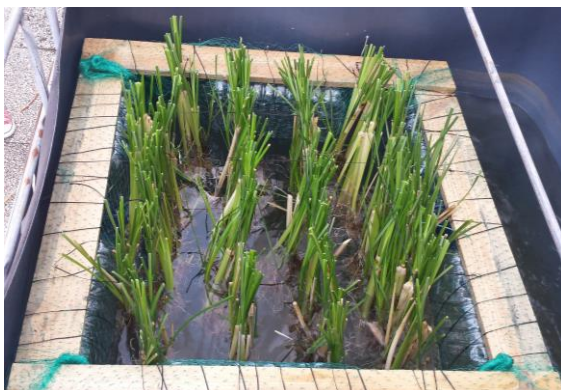
Figura 6 - Leitos flutuantes contendo Vetiveria Zizanioides (imagem da esquerda) e Phragmites Australis (imagem da direita) da Instalação Piloto.
