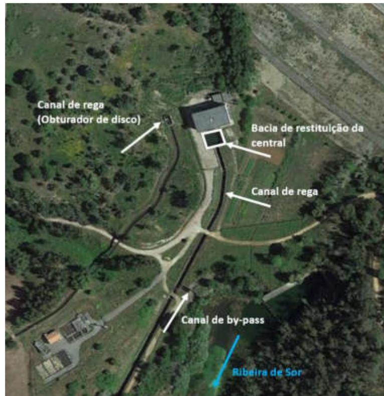
Figura 4.1 – Localização da bacia de restituição da central e canal de *bypass*.
