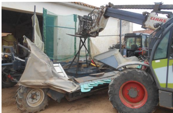
Figura 5 – Montagem da caixa vibratória da unidade esquerda da MCCA após reparação
