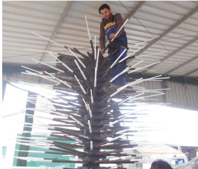
Figura 7 – Aspecto da montagem das varetas num dos mastros da MCCA
