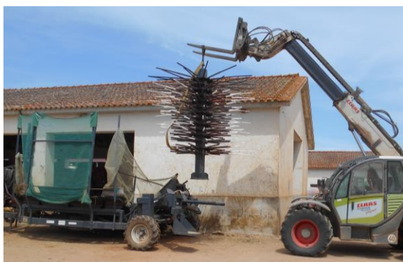
Figura 3 – Desmontagem do mastro vibratório da unidade esquerda da MCCA
