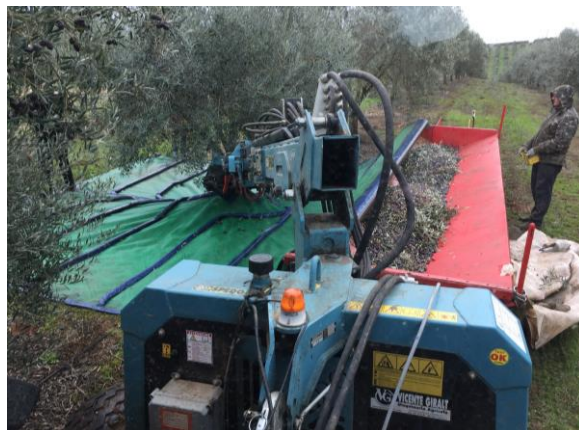
Figura 13 – Colheita descontínua com vibrador semi-montado em tractor e recolha com semi-reboque enrolador de panos
