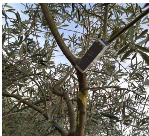
Figura 9 – Sensor com proteção colocado em ramo de árvore
