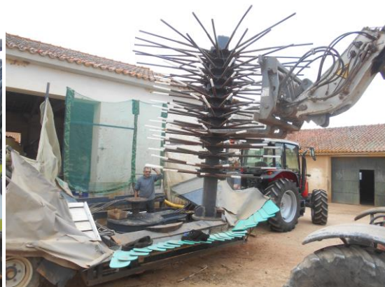
Figura 6 – Montagem do mastro vibratório da unidade esquerda da MCCA
