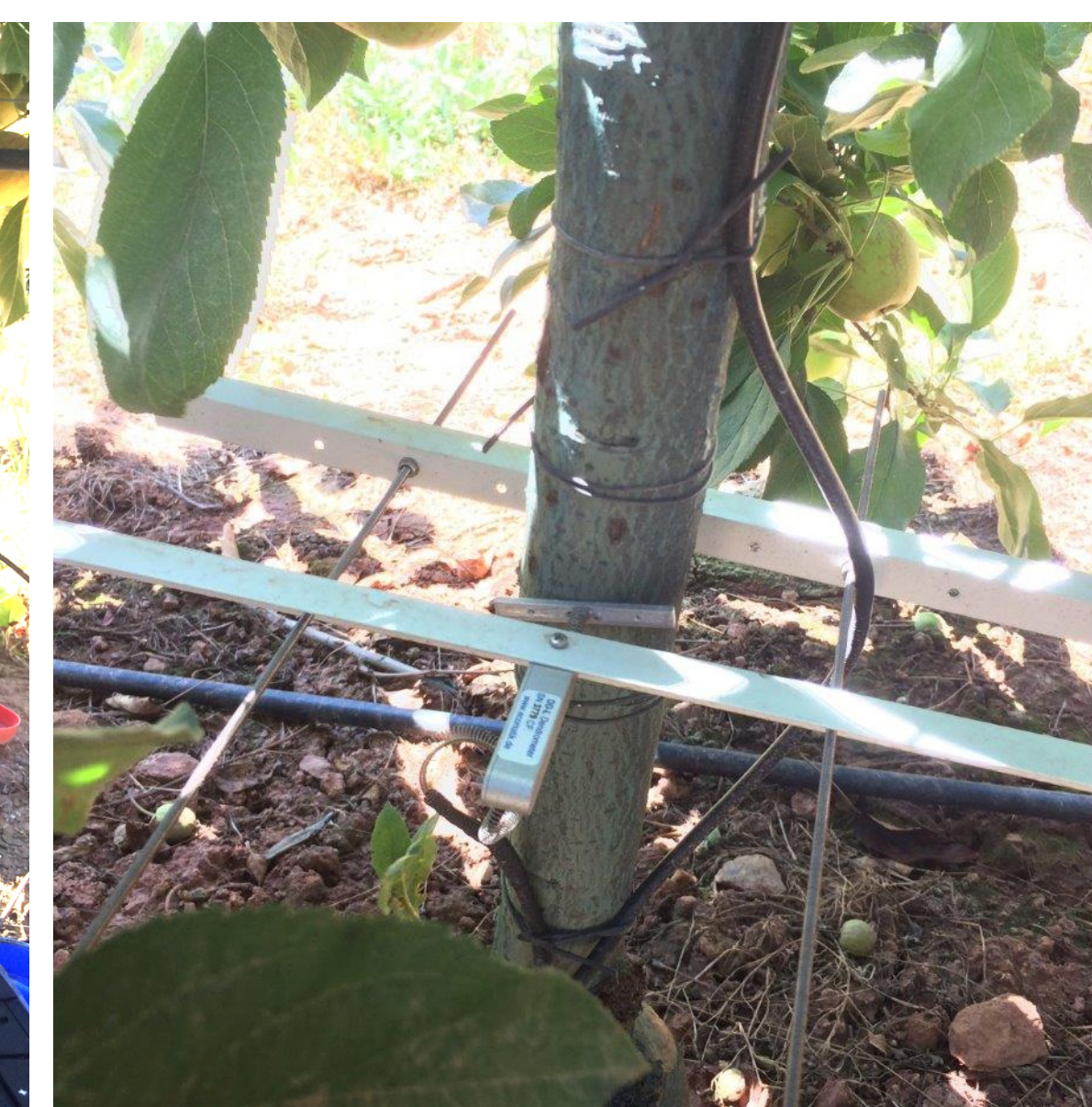
Sistema de monitorização do crescimento do tronco
