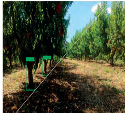
Figura 6.6 – Função linear gerada pela deteção de dois troncos de pessegueiros.
