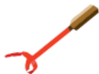
Figura 28. Arranca-bicas. Espécie de alicate usado para retirar as bicas dos pinheiros no final da campanha.
