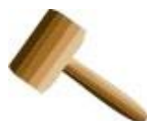
Figura 15. Maço. Martelo grande de madeira, que serve para bater no cabo do mete-bicas quando se faz o entalhe para colocar a bica no tronco do pinheiro. Serve igualmente para fixar o prego que irá suportar o púcaro.
