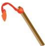
Figura 25. Raspadeira. Ferramenta de cabo longo, com uma lâmina na ponta usada para raspar e retirar, no final da campanha, a resina seca (raspa) que ficou agarrada à fiada de renovas.
