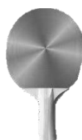
Figura 22. Protetor. Peça metálica colocada por cima dos púcaros ou sacos para evitar que impurezas se depositem nestes recipientes aquando a renova.
