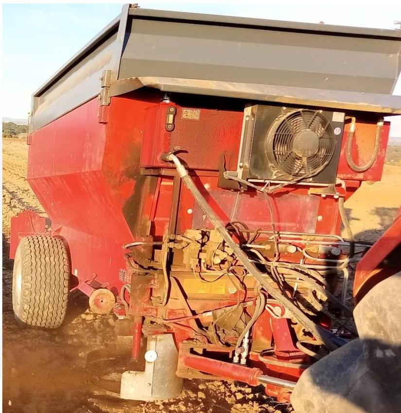
Sistema hidráulico autónomo
