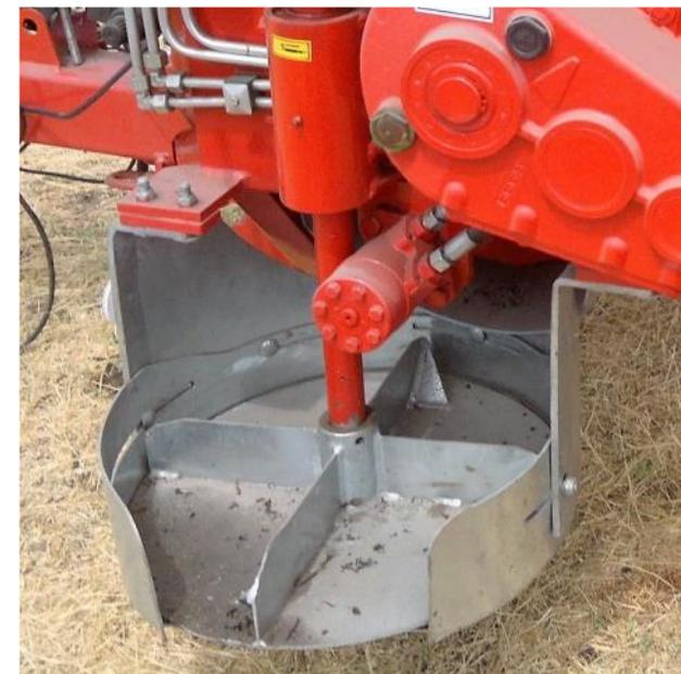
Posicionamento deflectores rotores espalhamento
