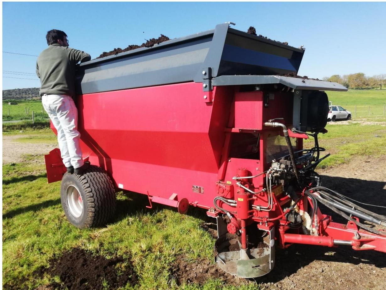
**Semi-reboque distribuidor de estrume HERCULANO H2RSP**
