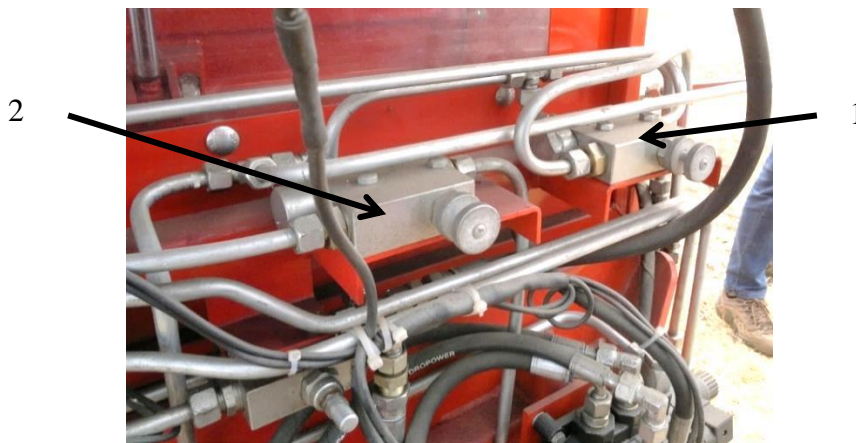
Legenda: 1- Regulação do transportador correntes; 2 – Regulação rotores espalhamento Figura 9 - Válvulas de controlo dos componentes do espalhador de estrume
