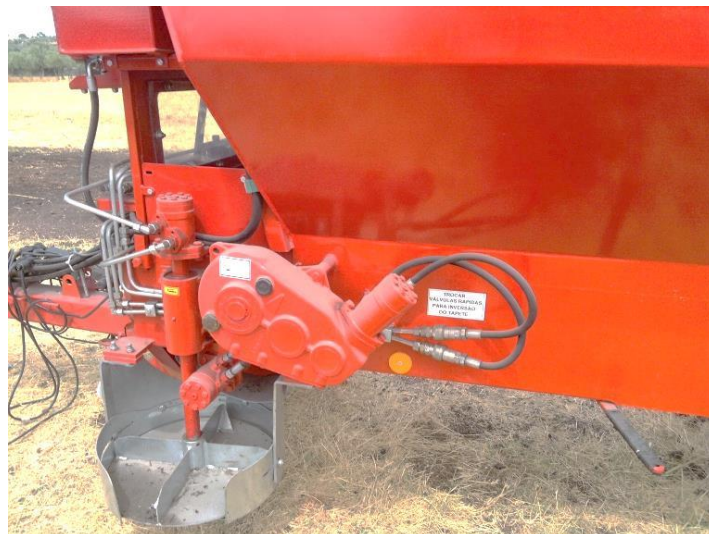
Figura 8 - Rotores de espalhamento (rotor esquerdo)
