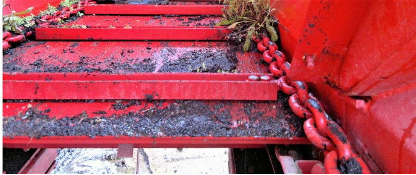
Figura 5 - Transportador de correntes e travessas do fundo da caixa de carga
