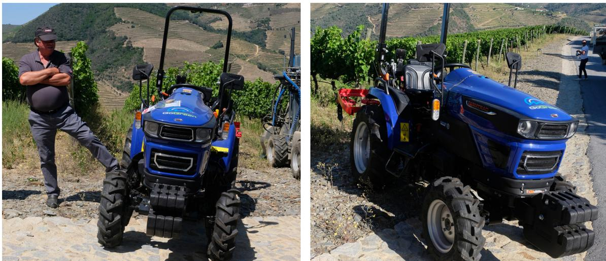
Figura 19 – Perspectiva frontal e lateral do tractor elétrico Farmtrac
