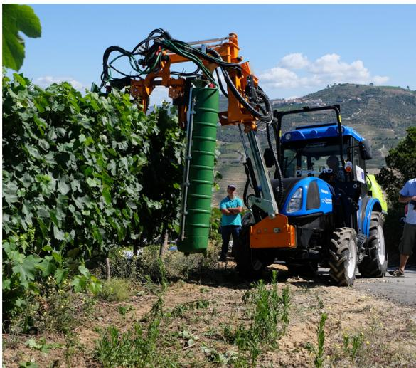
**Figura 7** - Sistema de pulverização (painéis)
