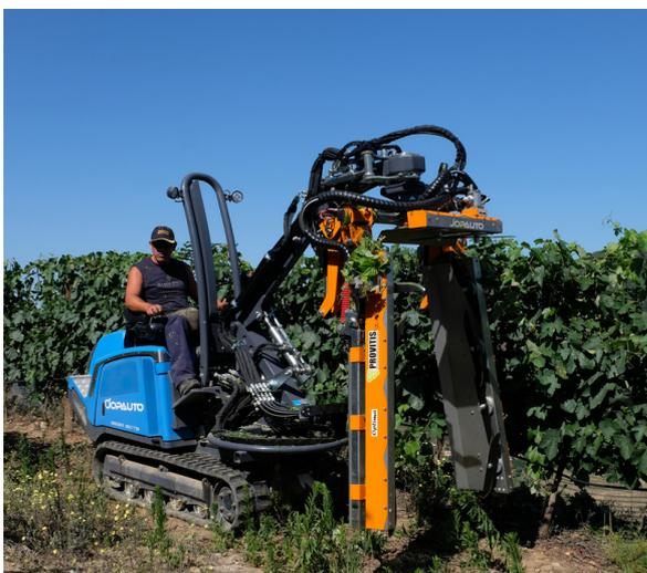
Figura 3 - Despontadora acoplada ao GAIER
