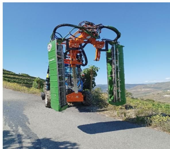
**Figura 10** - Painéis recuperadores recicladores com ventiladores tangenciais e acoplados ao pivot rotativo
