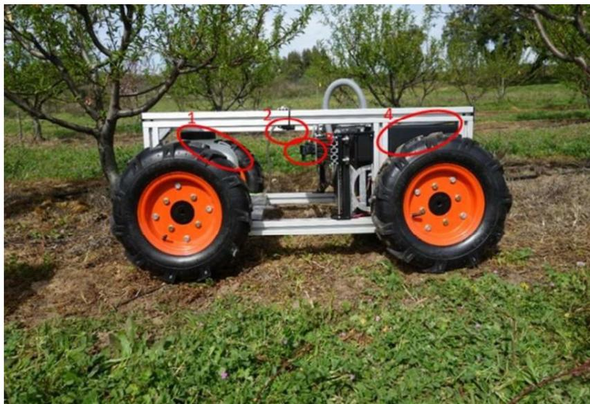
**Figura 10** – Rover Robótico de Aplicações Agrícolas. Legenda: 1) Reservatório de herbicida. 2) Sistema de visão computacional. 3) Manipulador robótico cartesiano com bico pulverizador. 4) Sistema de controlo.
