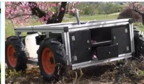
Fig. 2. Rover Robótico multitarefa para Atividades Agrícolas (R2A2).
