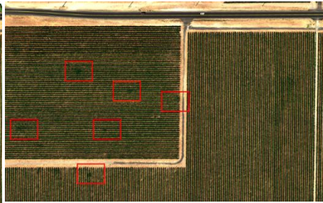
B) Fugas na irrigação = crescimento excessivo.
