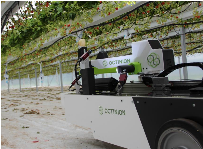
(a) Rubion harvesting robot (De Preter 2018).
