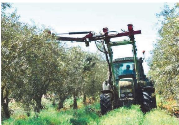
**Figura 1** – Corte horizontal da copa com máquina de podar de discos
