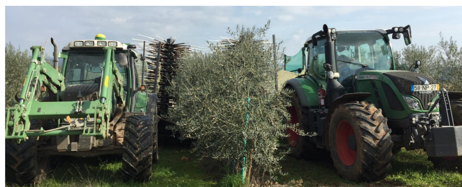
Colheita contínua Máquina Colheita Contínua de Azeitona - sebe larga
