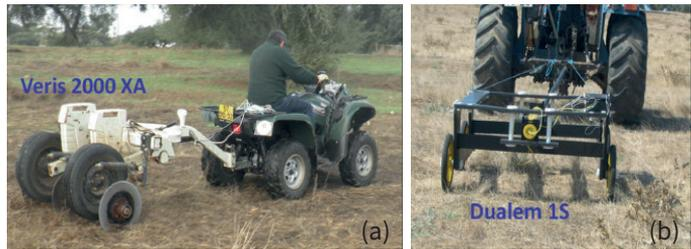
Figura 14. sensores de CEa existentes atualmente no mercado: (a) sensores de contacto (como o sensor Veris 2000 XA) que utilizam elétrodos em discos, que fazem o contacto com o solo, para medir a resistividade elétrica (o inverso da condutividade elétrica); e (b) sensores de proximidade, sem contacto (como o sensor Dualem 1S), baseados no princípio da indução eletromagnética. *Créditos: Serrano et al., 2024a*
